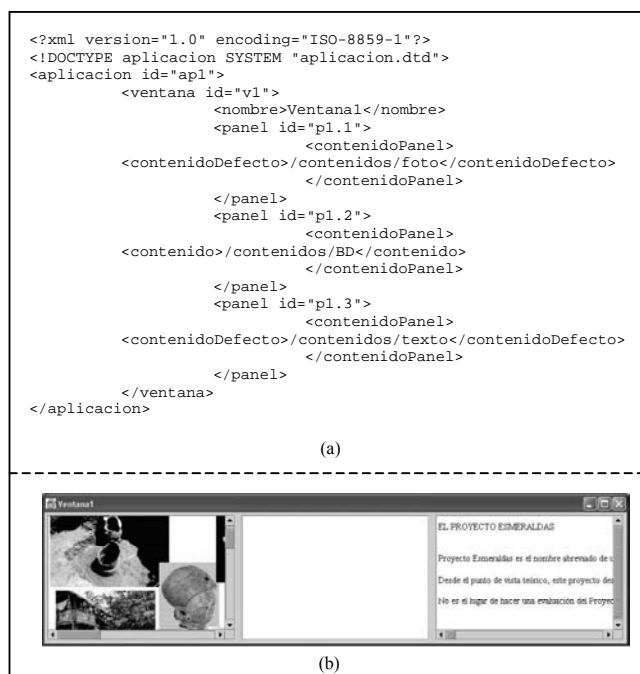
Fig. 6. (a) Codificación XML del esquema navegacional. (b) Prototipo generado. La extracción de los contenidos de la base de datos por el momento se realiza de forma manual .
